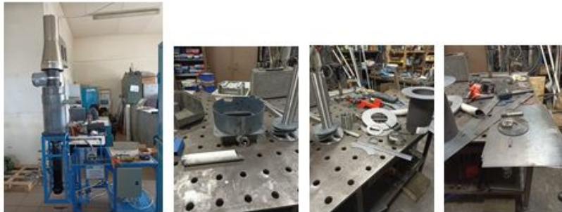
Model experimental Instalatie de generare a energiei termice tip TLUD cu senzori și sistem de control automat
